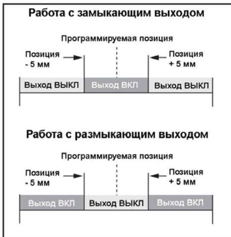
Рис. 4 Программирование выходов в режиме “Auto-Window”
