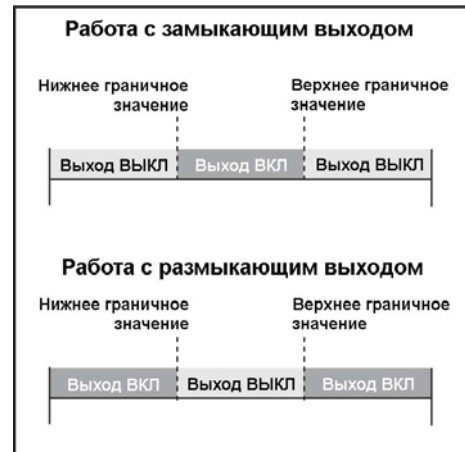
Рис. 3 Программирование независимых нижней и верхней границ
