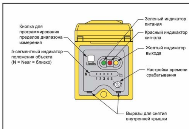
Рис. 1. Панель датчика Q45U с аналоговым выходом
