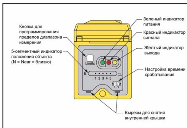
Рис. 1. Панель контроллера Q45UR с аналоговым выходом
